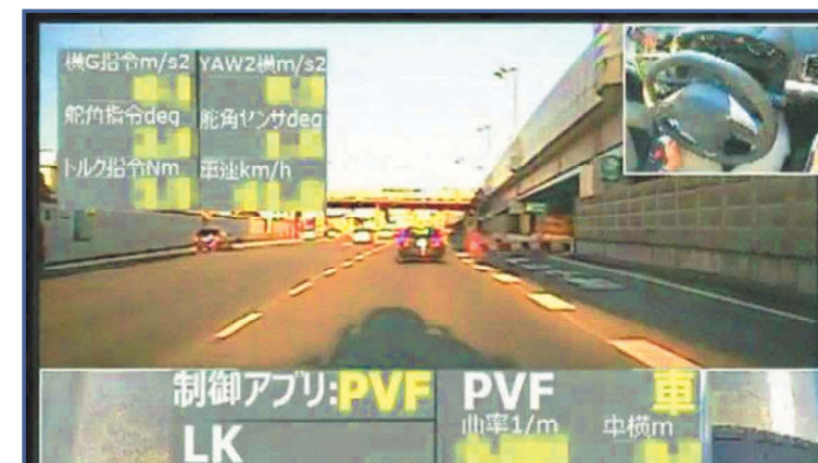
モデル予測制御を使用したACCアルゴリズムの公道テスト
